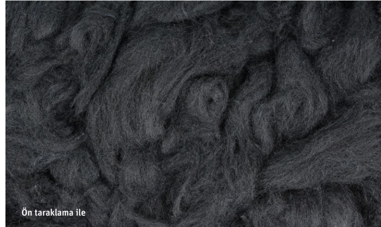
Şek. 1: Ön taraklama uygulanmış materyal iplik parçacıkları içermez; bu da geri dönüştürülmüş malzemenin eğirme özelliğini artırır.
