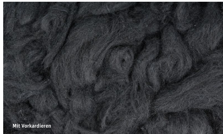
Abb. 1: Das vorkardierte Material enthält keine Garnstücke, was die Spinnfähigkeit des recycelten Materials verbessert.
