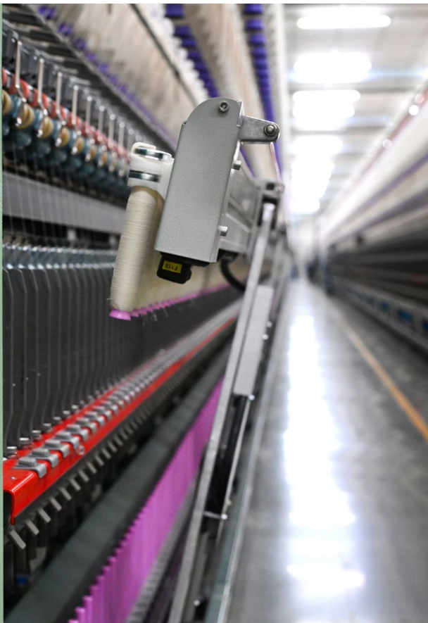
Abb. 1: Die G 38 dofft in 90 Sekunden und steigert so die Produktion.
