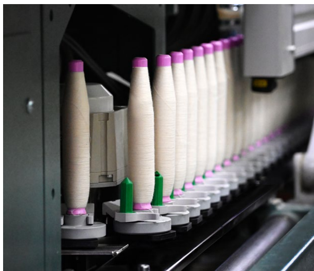
Abb. 3: 12% schnellerer Kopstransport mit SERVodisc
