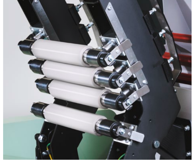
Optimize edilmiş yük dağılımına sahip üst silindirler
