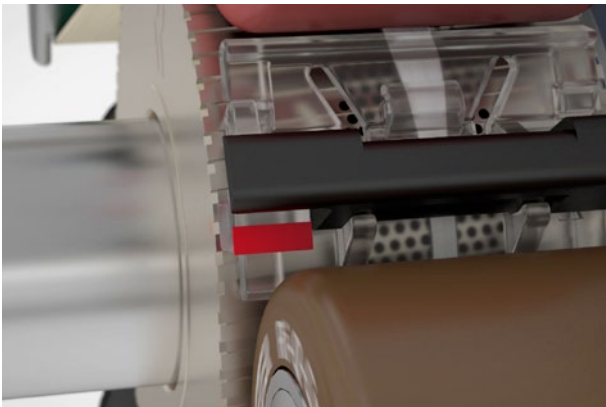
Hava kılavuz elemanı üzerindeki kırmızı işaret, kompaktlama ünitesinin kontrol edilmesi gerektiğini gösterir.
