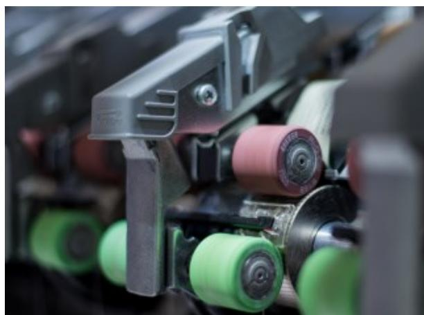
采用 Com4®技术的紧密纺纱机 K 46 的集聚装置
