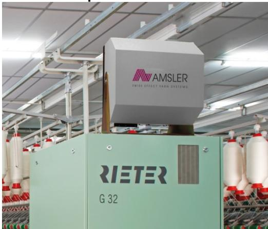
Bildlegende: VARIOspin ist ein integriertes Effektgarnsystem für die wirtschaftliche Herstellung modischer Effektarne.
