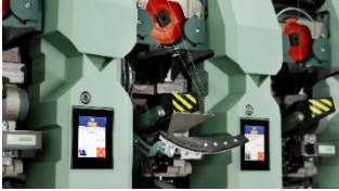
J 70 – Düşük iplik üretim maliyetleri ile hava jetli iplik eğirme Kimlik: 98477
