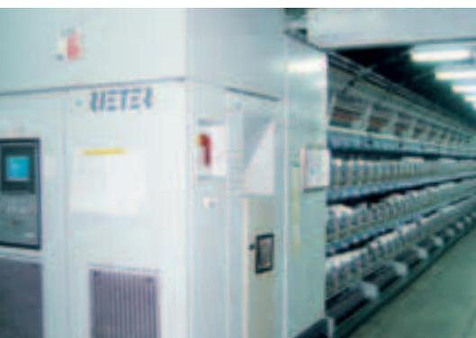
Die neue Rieter-Texturiermaschine GOAL 1201 SDS, die flexibelste Texturiermaschine für alle Arten von Chemiefasern dank der einzigartigen, energiesparenden Heizer-Technologie von Rieter.
