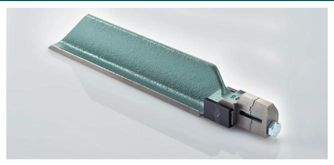
印度 Madura Coats 公司自 1995 年以来运行使用了 12 台立达梳棉机 C 50, 该公司向立达的售后服务团队提出要求,希望能够找到一种可持续的解决方案来延长梳棉机的使用寿命。铸铁盖板骨两端已经超过使用寿命,必须全部更换。立达和 Madura Coats 共同提出了将新一代梳棉机的滑靴概念融入老式 C 50 梳棉机的想法。这项维修翻新有助于延长机器寿命并提高产能。盖板骨再利用还可以避免处理超过4吨的铸铁,有助于客户实现其环保目标。
