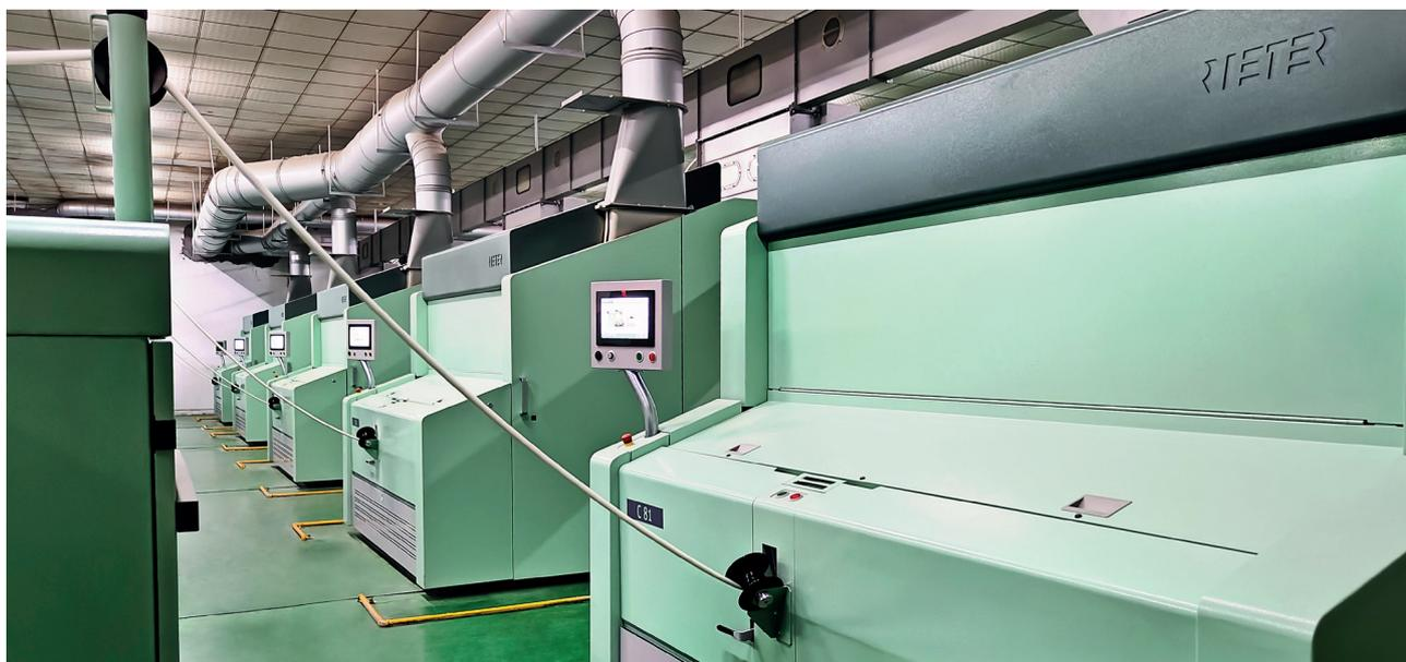
潜江市昌云纺织有限公司成立于2016年，主要生产Ne 3-60 转杯纺纯棉或混纺牛仔纱、针织纱、竹节纱和超柔纱。为了确保出色的纱线质量和经济效益，昌云非常重视设备的投入，在企业发展历程中不断升级生产设备。近期，昌云引进了立达清梳联，包含一机两线开清系统和最新梳棉机C 81。纤维准备工序的全面升级，为获得条干匀、杂质少、强力稳定的纱线提供了保障。
