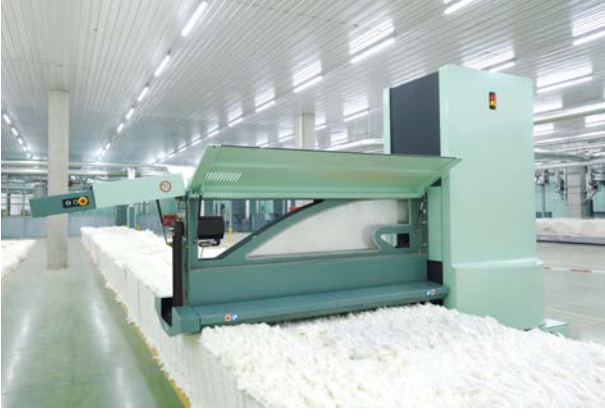
Altı UNIfloc A 12 balya açıcı, K 46 kompakt İplik makinasını besler
