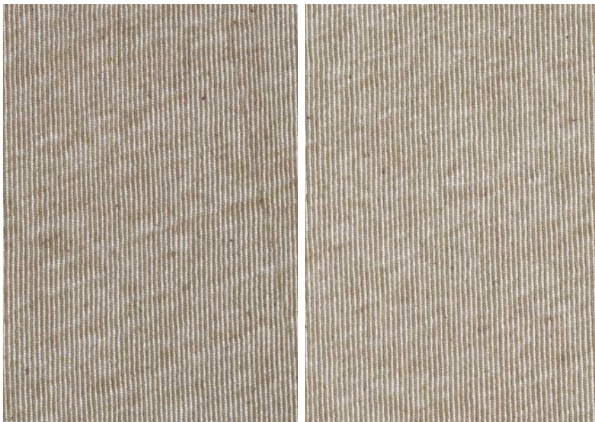
图23：对比含一个和两个牵伸区的直接流程时，含两个牵伸区的流程生产的面料具有更好的条干均匀度。
