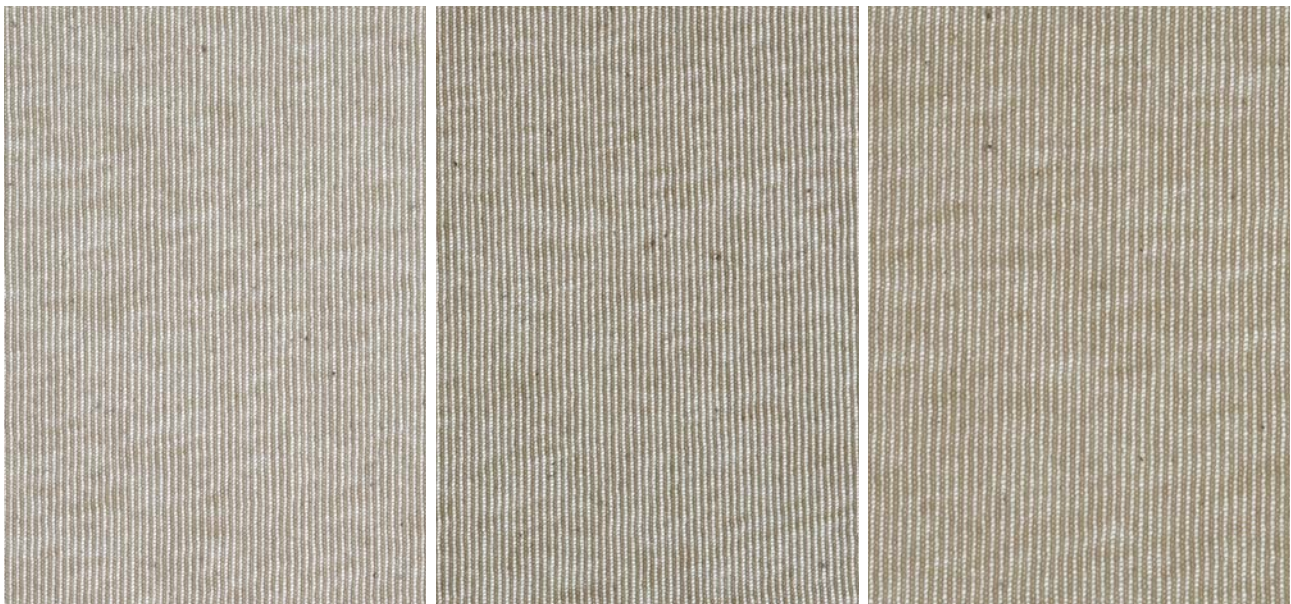
图19：加工100%棉时，使用传统流程可实现理想条干均匀度。
