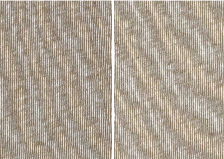
Şek. 23: Bir veya iki çekim bölgesi direkt prosesler kıyaslandığında iki çekim bölgesi olanı daha düzgün kumaş üretir.
