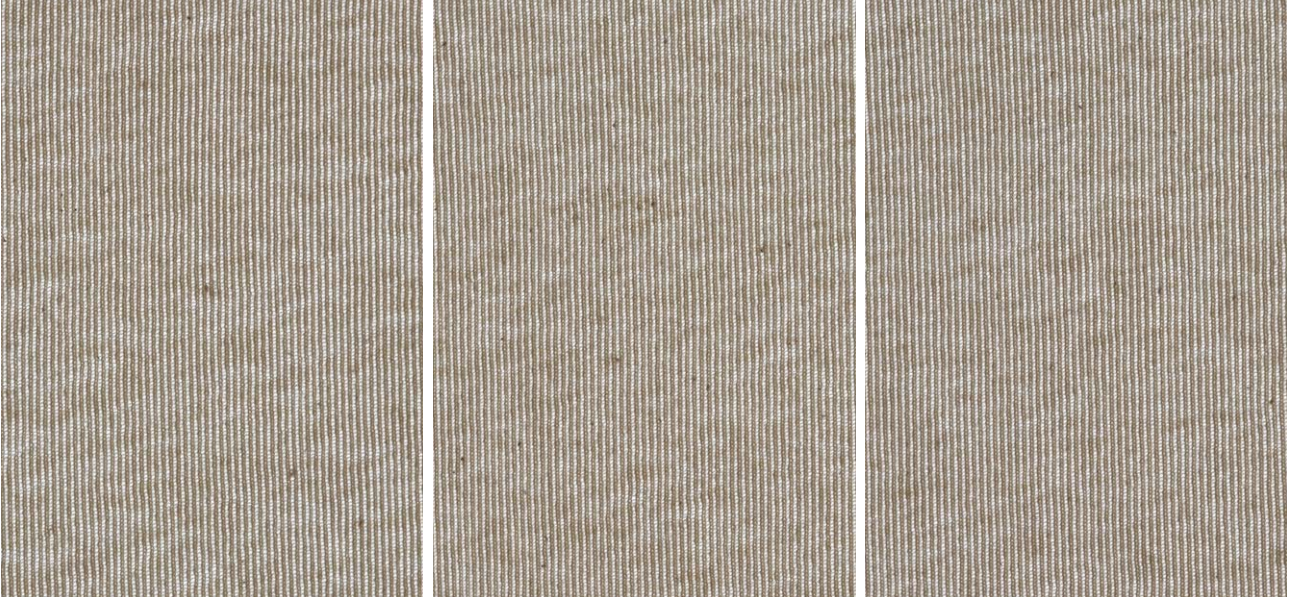
Şek. 20: %70 pamuk ve %30 penye telefiyle ayrı prosesler arasında görülebilir fark yoktur.
