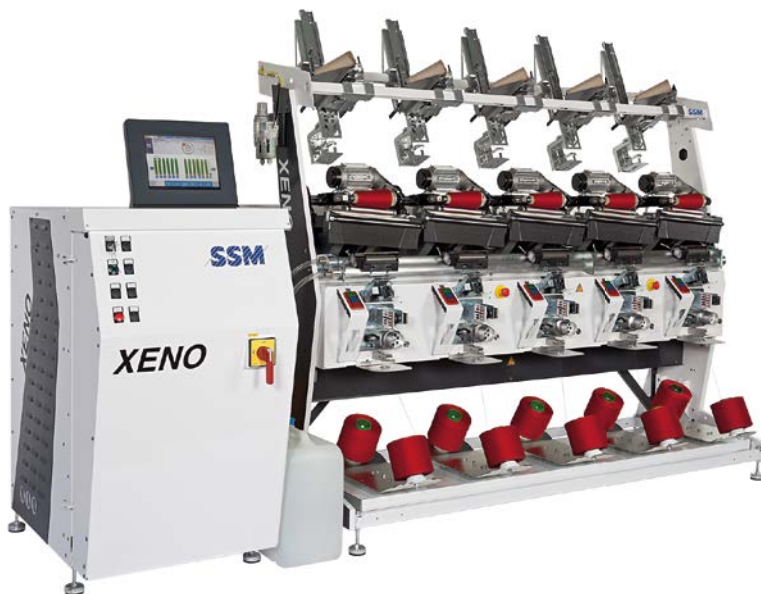
SSM XENO-YW：这些高性能卷绕装置的能耗仅为每锭18瓦到100瓦，具体取决于应用场合和选用的卷绕参数。
