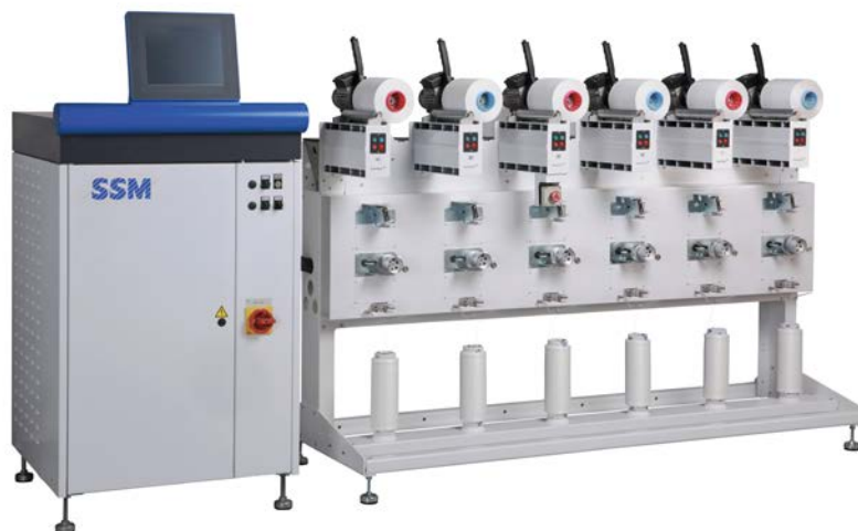
SSM PWX-W：能耗为每锭30瓦到70瓦不等，具体取决于应用场合和选用的卷绕参数。
