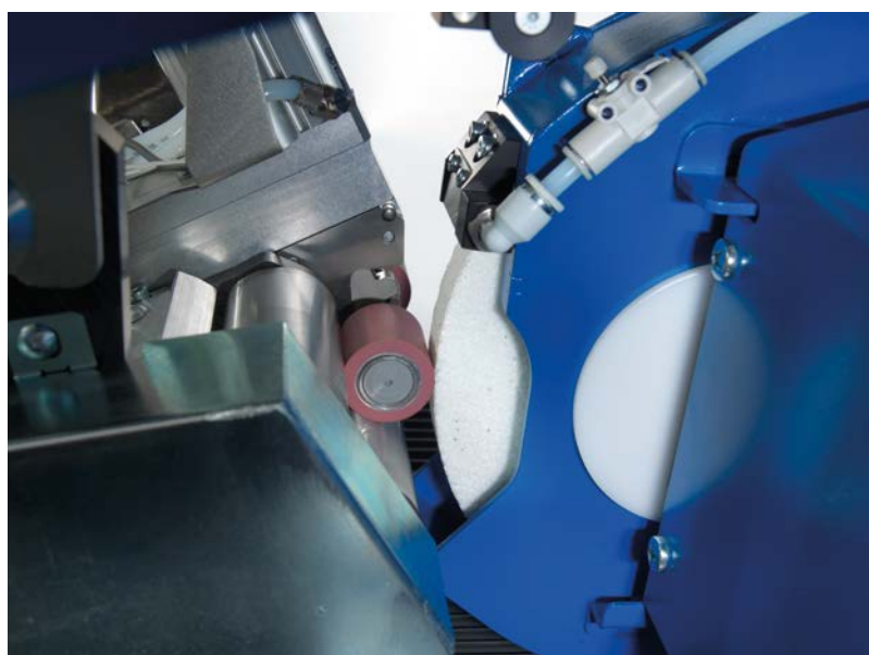
图1：30毫米直径皮辊的磨削位置
