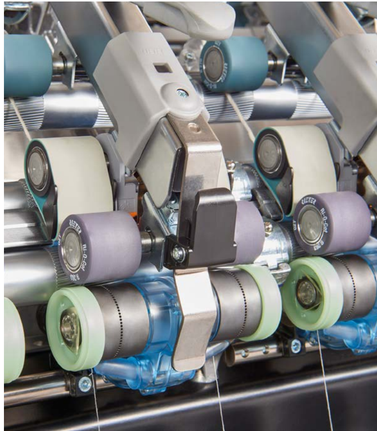
此外，紧密纺装置COMPACTdrum还可装到已有的立达机器上使用，以经济地生产优质紧密纱。
