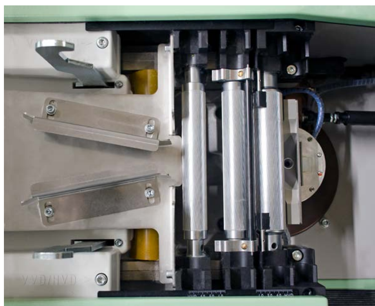
图4：加工短纤维含量达到或超过27%的原生棉时，必须使用两个牵伸区。
