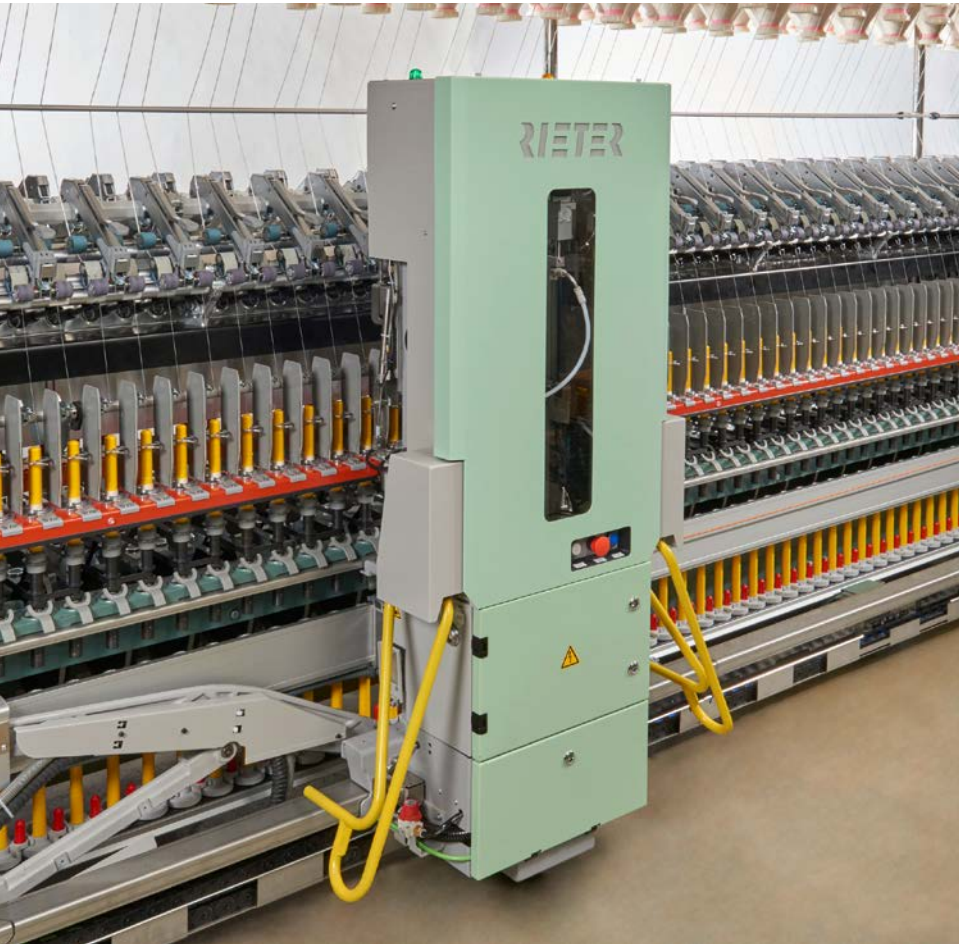
Şek. 1: Bağlama robotu ROBOSpin, verimliliği artırır ve personel maliyetlerini düşürür.
