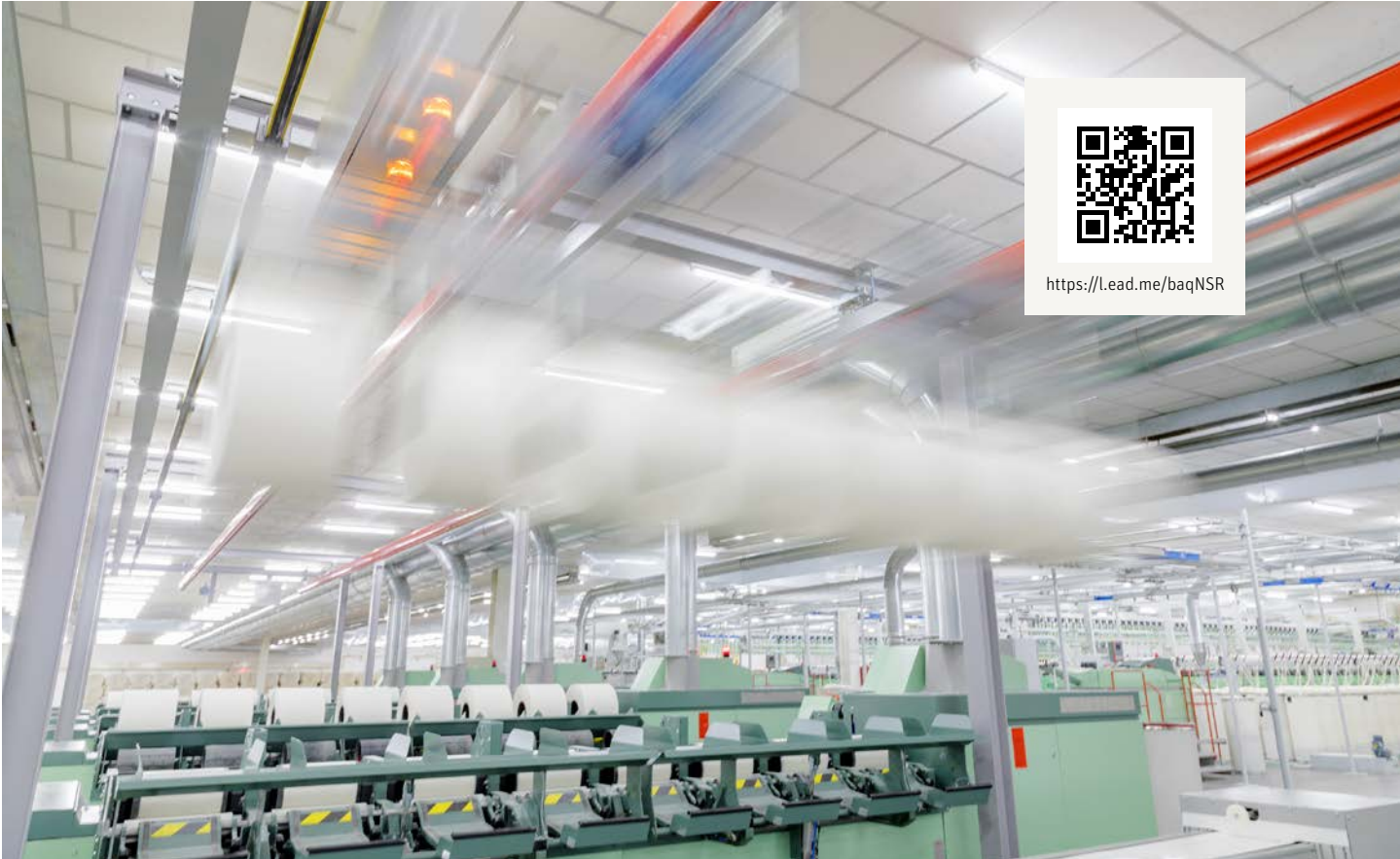
Şek. 1: SERVOLap, penye dairesindeki operatör sayısını azaltır ve verimliliği artırır. Animasyonda nasıl çalıştığı gösterilmiştir – QR kodunu tarayın.
