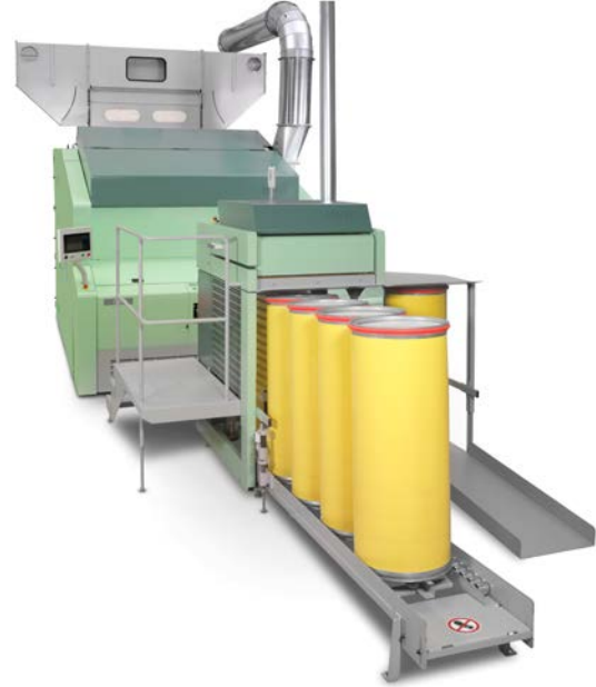
Şek. 2: Regülebli cer modülü RSB-Module 50 ve C 80 tarak makinası, yüksek kısa elyaf içeriği için en uygun kombinasyondur.
