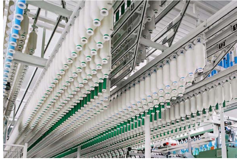
Şek. 3: SERVOTrail, fitil bobini taşıma işlemini otomatik hale getirir ve yerden tasarruf sağlar.
