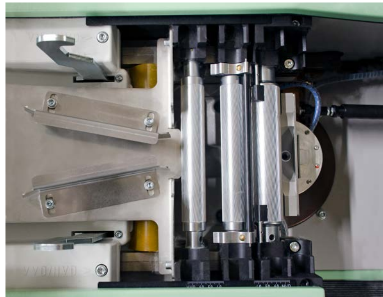
Şek. 4: İşlenmemiş pamuk kullanırken, %27 kısa elyaf içeriğinden itibaren iki çekim bölgesi olması çok önemlidir.
