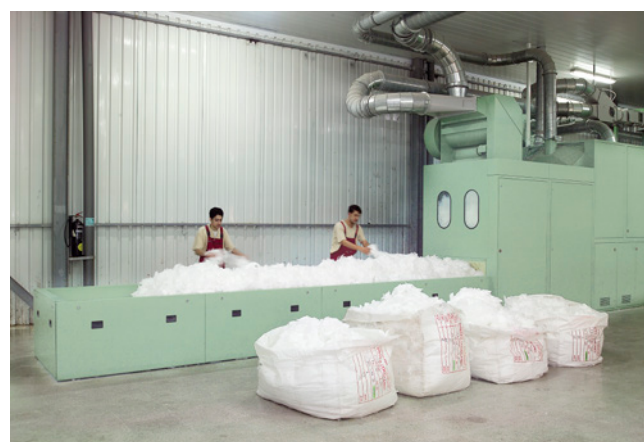
Смешивающий кипоразрыхлитель В 34: универсальность смешивания при небольших партиях
