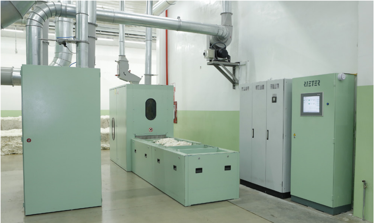
Дозированная обратная подача отходов из трепального отделения и кардочесальной машины
