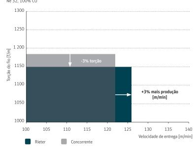
uma menor torção do fio e, consequentemente, uma produção maior. Os resultados de fiação para várias aplicações de algodão mostraram que foi possível reduzir a torção do fio em 3% com a mesma velocidade do rotor, resultando numa produção 3% superior. O consumo de energia foi mantido consistentemente baixo – e ainda assim foi alcançada uma maior resistência do fio em comparação com outros.
