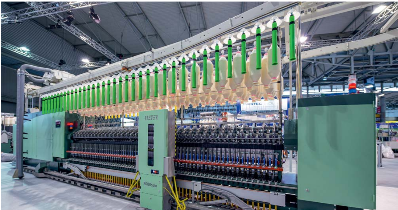
Schon erfolgreich im Einsatz: der Anspinnroboter ROBOspin, der Fadenbrüche behebt und damit eine hohe Produktivität sichert.
