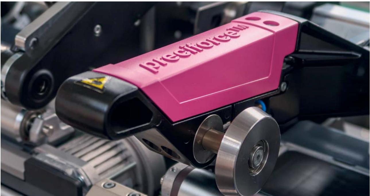
Vielbeachtet an der ITMA 2019: die SSM-Neuheit preciforce, ein System zur Optimierung des Spulenaufbaus auf Präzisionspulmaschinen.
